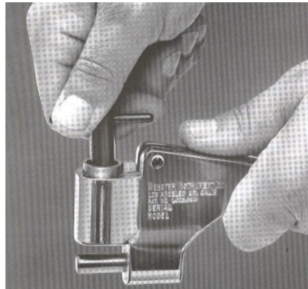
Fig. 3 Ajustando la carga del resorte
