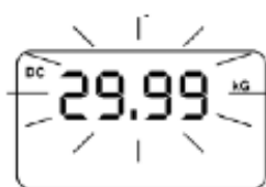
Figura 3-9 Indicador de sobre rango
