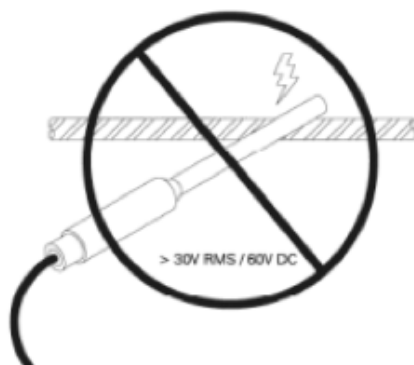
Figura 3-2 Advertencias eléctricas de la sonda
