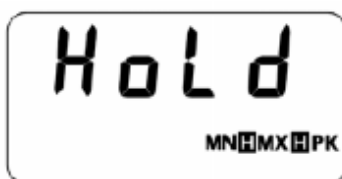
Figura 3-13 Función de retención
