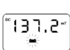
Figura 3-8 Indicador de batería baja
