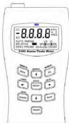
Figura 3-3 Rasgos de funcionamiento
