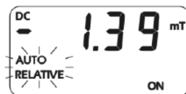
Figura 3-17 Función AUTO RELATIVO
