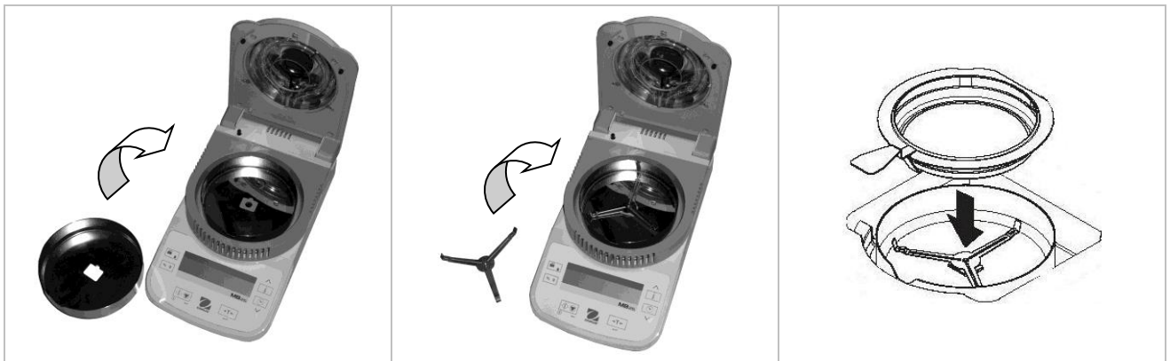
(1) Instale y coloque la pantalla contra corrientes de aire
