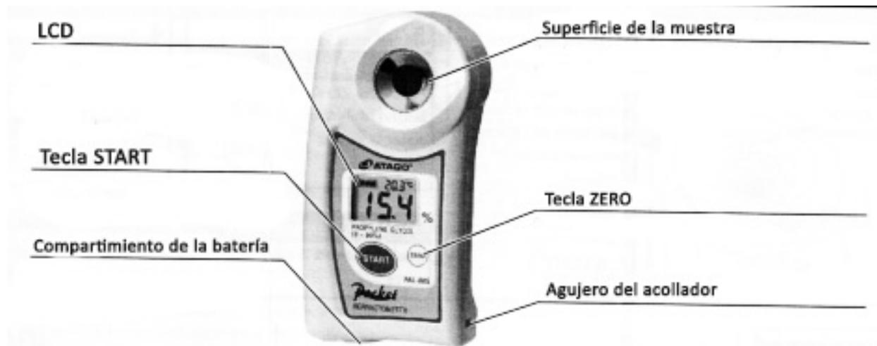
**LCD:** Se muestran los resultados de medición, temperatura del prisma y restante de carga de la batería. El valor mostrado es un ejemplo.
