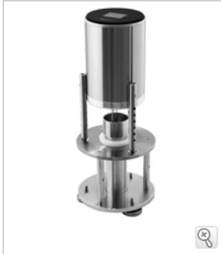
Es posible la medición de baja viscosidad ( $1 \sim 2.000\text{mPa} \cdot \text{s}$ ).
